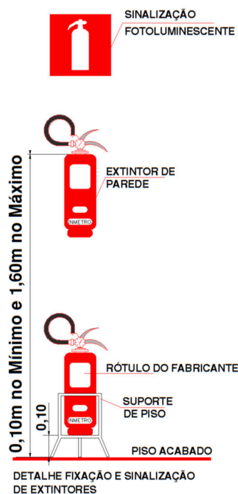
Figura 1. Fixação de extintor
